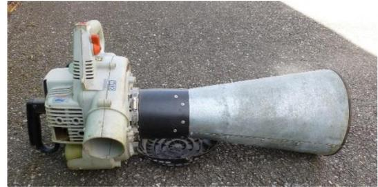
Photo 5 : Aspirateur-souffleur utilisé pour le piégeage des arthropodes
